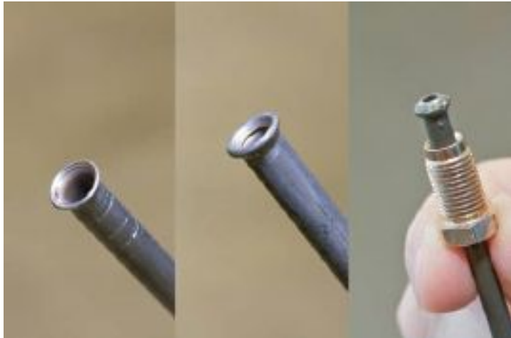
Single flare, double flare, and ISO flare.
