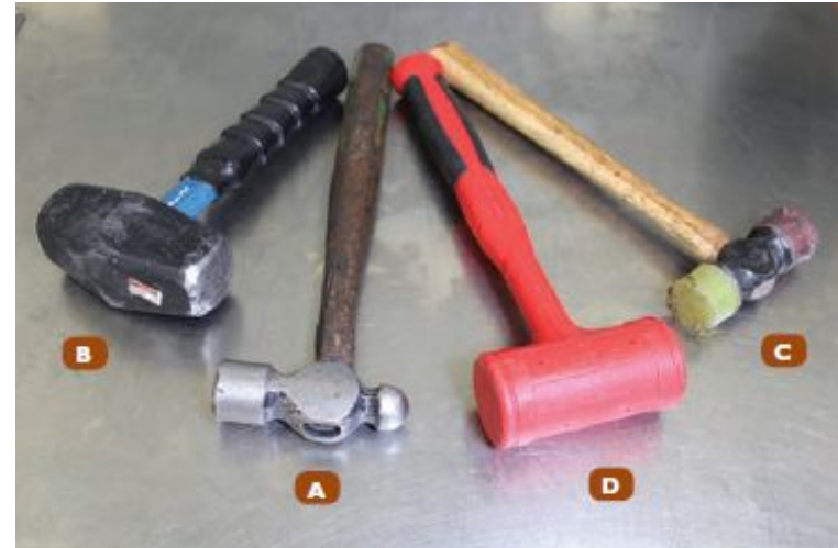
A. Ball peen hammer. B. Sledge hammer. C. Soft-faced hammer. D. Dead blow hammer.
